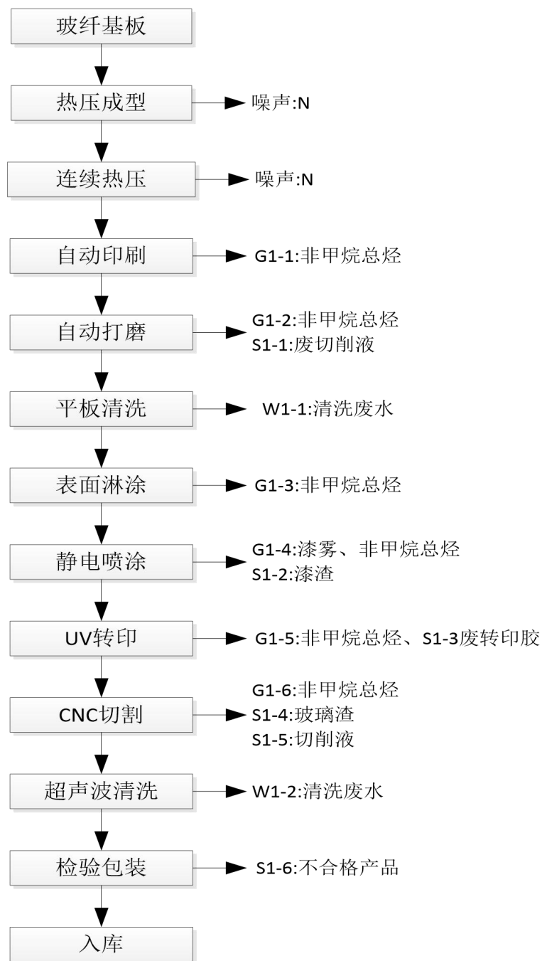
图 2-4 玻纤盖板生产工艺流程及产污节点图
